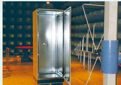
從箱體的前面發放在 0.01-30 MHz 的磁場 (H) 和 30 MHz-1 GHz 的電場 (E) 範圍的信號源。
